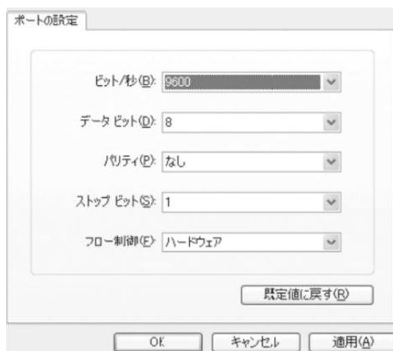
図 5 シリアルポートとシリアルケーブル 図 6 シリアルポート(RS-232C)の通信パラメータ設定画面の例
