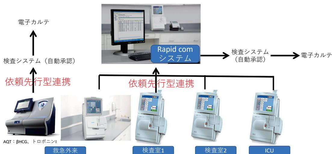
Fig. 2 救急外来におけるPOCT対応装置接続事例
