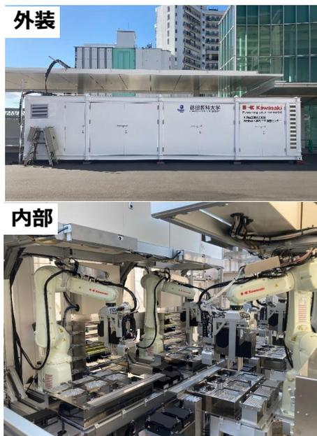
Fig. 4 自動PCR検査システム
