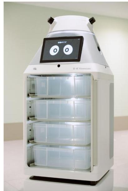
Fig. 5 自動配送ロボット「FORRO (フォーロ)」
